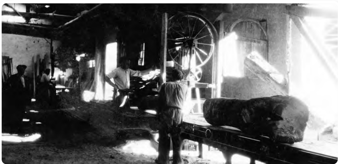
En el aserradero de Ibarra se cortaban los troncos en tablonces de 12 centímetros de anchura que luego se dejaban secar.
